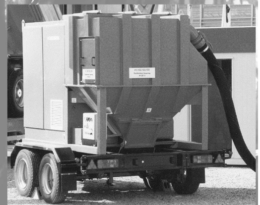
Sauganlage auf Fahrgestell
