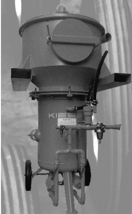
Strahlkessel mit Zyklon- aufsatz
