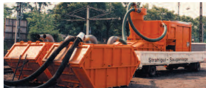
Sauganlage mit vakuumfesten Wechselmulden und Zyklonmulde
