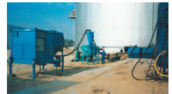
Sauganlage mit Zubehör im mobilen Einsatz (automatischer Staubaustrag über Doppelkegelschleuse)
