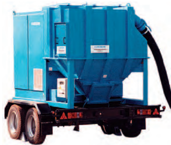
Dieselsauganlage auf Tandemfahrgestell mit Straßenverkehrszulassung
